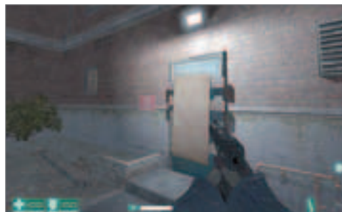
Работа шейдеров 3.0, ParallaxMapping дает картинку с неровностями стен
